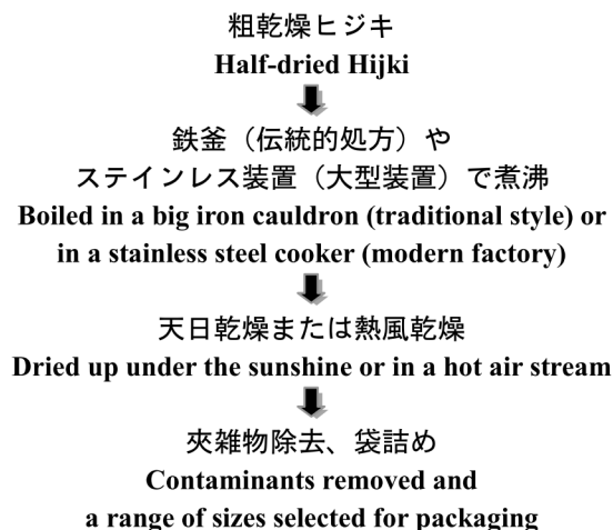
図1. 乾燥ヒジキ製造工程
